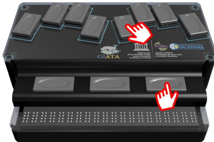
Figura 2. Configuración del volumen del dispositivo a 4, botones C3+4.
