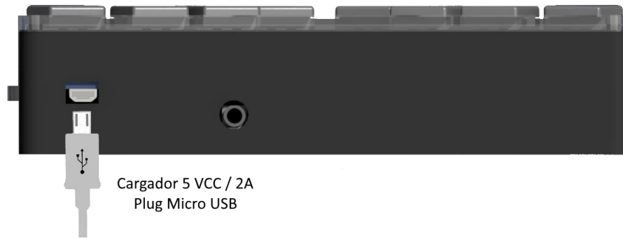
Figura 5. Conexión del cargador del prototipo de línea Braille.
