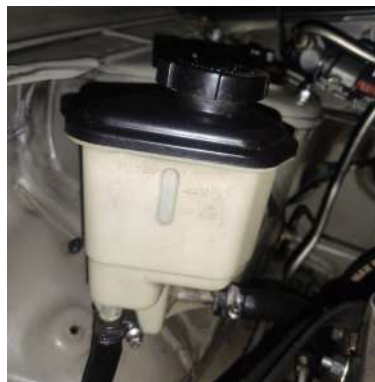
Figura 8. Revisión del deposito del líquido hidráulico
