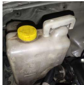
Figura 6. Revisión del depósito del refrigerante
