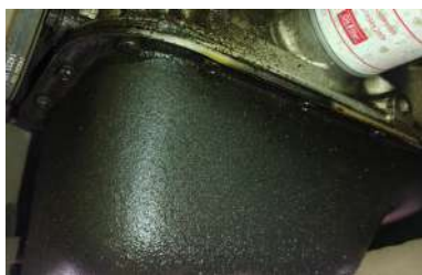
Figura 4. Análisis de la fuga del tapón del cárter
