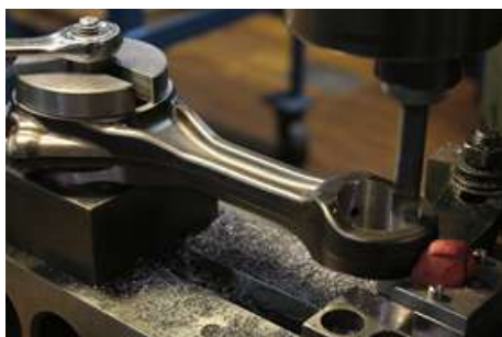
Figura 5. Mecanizado de una biela Fuente: connerengineering (2021)
