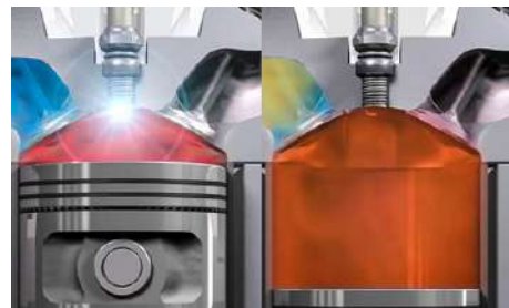
Figura 6. Explosión en el cilindro Fuente: actualidad motor (2021)
