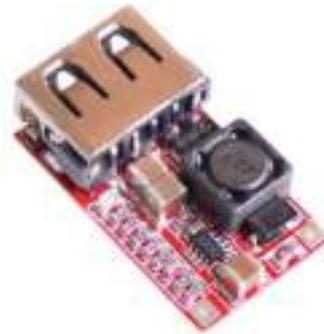
**Figura 6.** Regulador de voltaje CC
