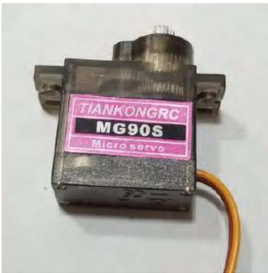
**Figura 6.** Servomotores (MG90S)
