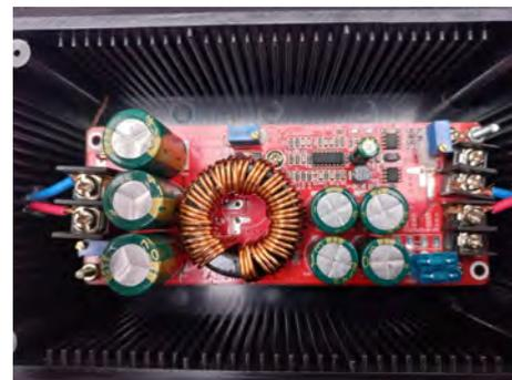
**Figura 3.** Convertidor de potencia DC-DC tipo boost
