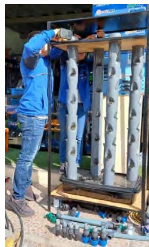
**Figura 1.** Construcción de la estructura del sistema aeropónico
