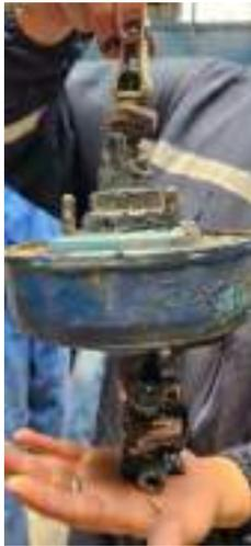
**Figura 8.** Servofreno en preparación
