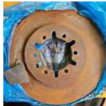
**Figura 6.** Disco oxidado para ser lijado
