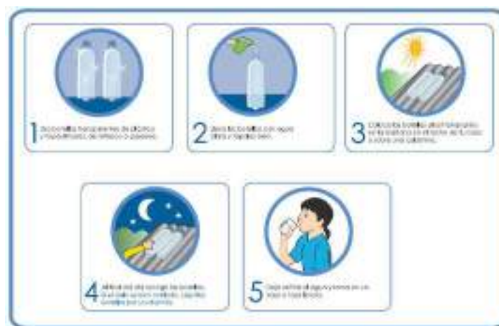
Figura 3. Protocolo operativo de cinco etapas para la desinfección solar del agua (SODIS)
