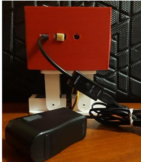
Figura 31: Conexión del cable de alimentación.
