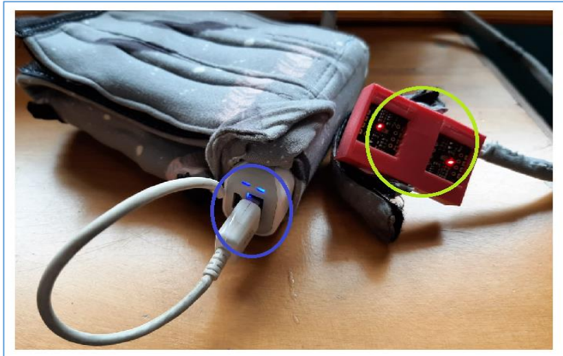
Ilustración 22 Alimentación de los sensores Fuente: [Autor]
