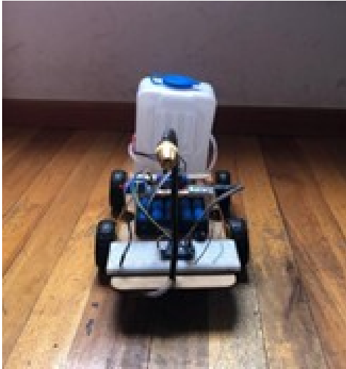
Figura 26. Descarga de agua del reservorio Fuente: Autores
