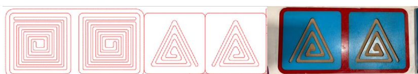
Figura 2. Planos del punzón y fotografía Fuente: Autores
