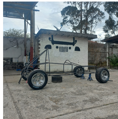
Figura 5. Vista lateral del chasis con los neumáticos rin 13 tipo semi slick Fuente: Autores
