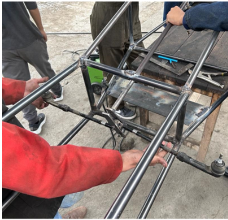
Figura 6. Diseño final de la dirección tipo mecánica del Fórmula SAE Matovelle Fuente: Autores
