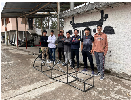
Figura 4. Diseño final del chasis en tubo negro del Fórmula SAE Fuente: Autores
