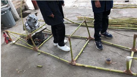
Figura 2. Construcción de las partes laterales del chasis Fuente: Autores
