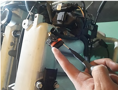
Figura 11. Medición de la señal del sensor MAF. Elaboración propia
