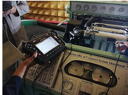
Figura 15. Medición del sensor MAF con el scanner Carman VG64. Elaboración propia
