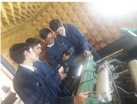
Figura 12. Toma de datos del sensor MAF. Elaboración propia
