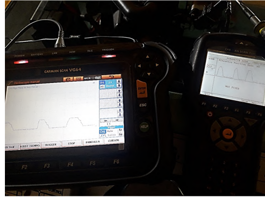
Figura 9. Señal en osciloscopio y escáner del sensor TPS. Elaboración propia
