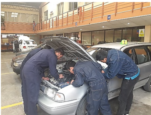
Figura 3. Ajustando el punto de encendido. Elaboración propia
