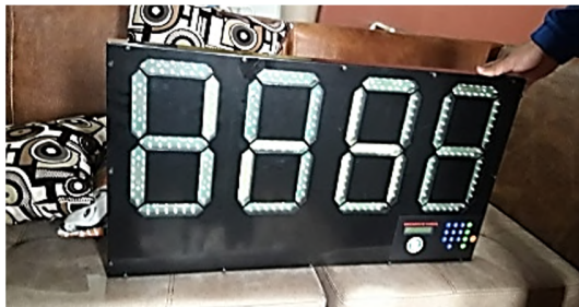
Figura 2. Estructura Finalizada, Arduino y relé. Elaboración propia
