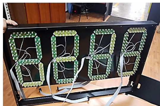
Figura 5. Estructura interna. Elaboración propia
