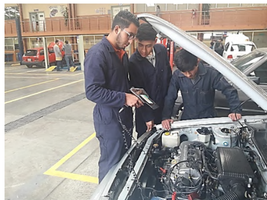
Figura 2. Verificando el punto de encendido del vehículo en estado inicial. Elaboración propia
