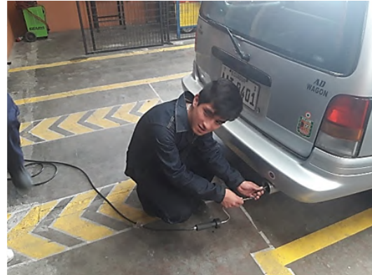
Figura 1. Insertando la sonda de muestreo en el escape del vehículo. Elaboración propia
