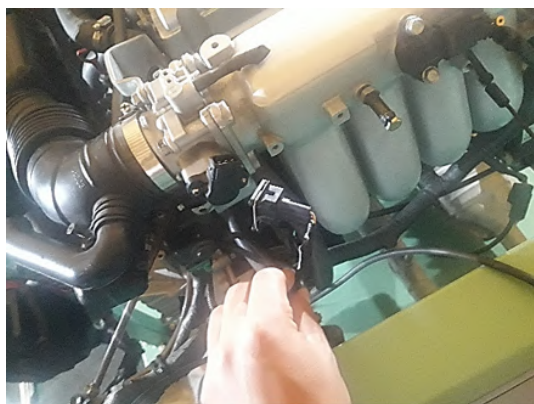
Figura 17. Desconexión del sensor TPS. Elaboración propia
