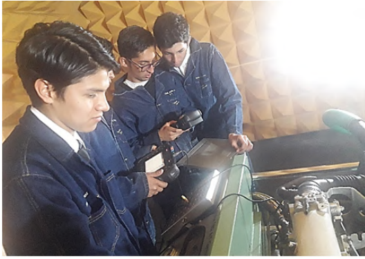
Figura 6. Toma de señales del sensor TPS. Elaboración propia
