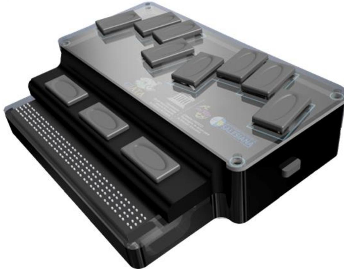
Figura 1. Prototipo de línea Braille.
